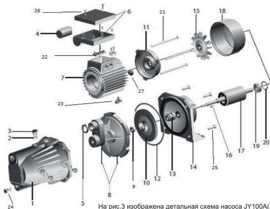
На рис.3 изображена детальная схема насоса JY100A(a)
